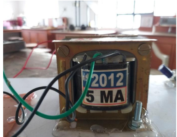
Fig: 3.4- Step Up Transformer
